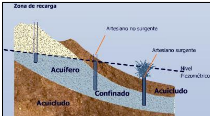
Figura 2. Pozos surgentes y no surgentes en ac ifero confinado (Mart n et al., 2006)
