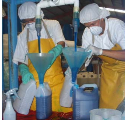
Figura 30. Llenado de líquidos utilizando boquilla de doble salida.
