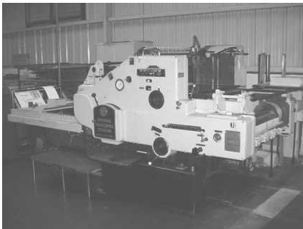
Figura 5. Troqueladora cilíndrica para estampado en caliente
