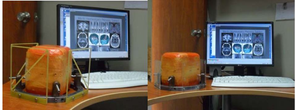
Figura 21. Marco estereotáxico colocado en el maniquí de bajo coste con fiduciales para TAC y para angiografía respectivamente.
