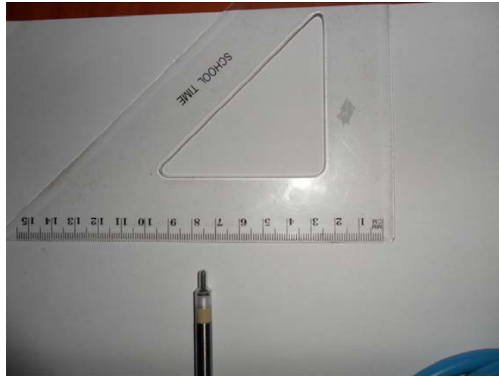
Figura 20. Micro cámara utilizada para medir haces de radiocirugía
