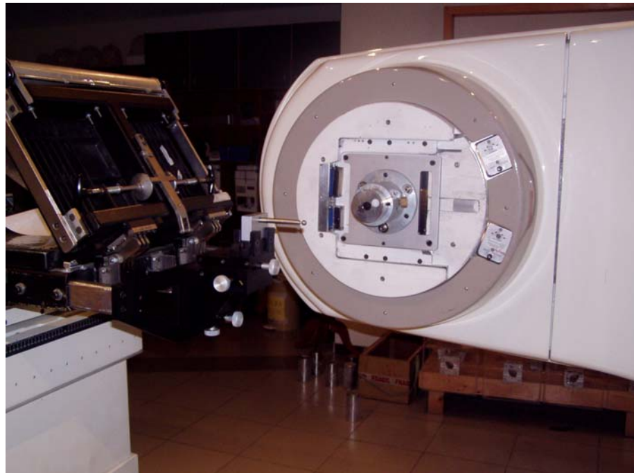
Figura 32. Sistema de ubicación de isocentro con esfera Localizadora ubicada en el isocentro
