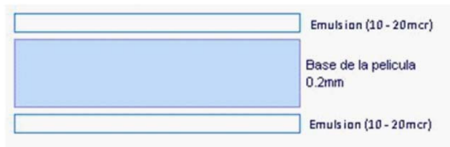
Figura 11. Sección transversal de película radiográfica
