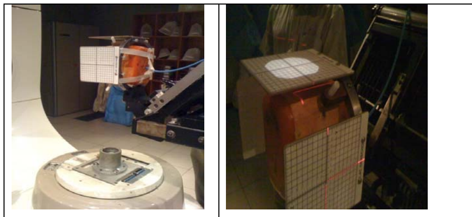
Figura 25. Posicionamiento del isocentro en el acelerador lineal.
