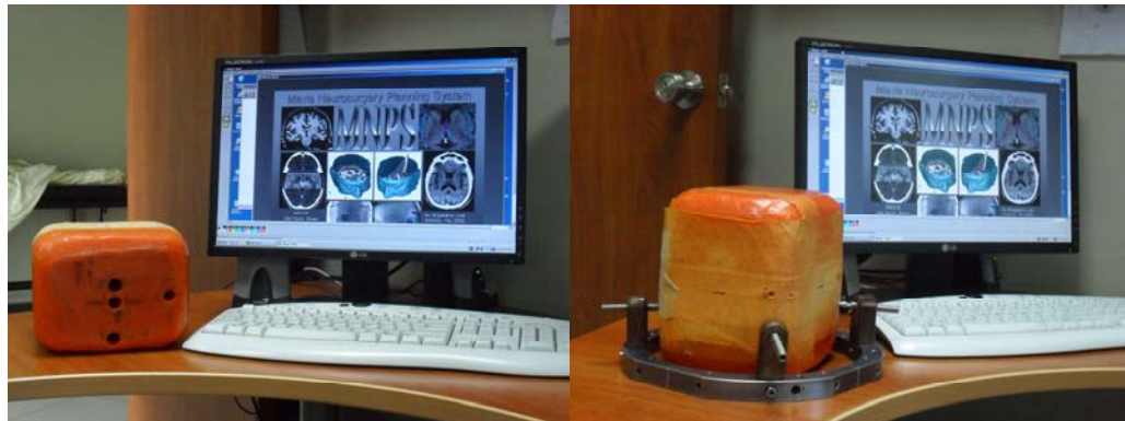
Figura 19. Maniquí de bajo coste diseñado para el control de calidad
