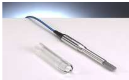
Figura 10. Ejemplo de dosímetro. Cámara de ionización PTW Farmer
