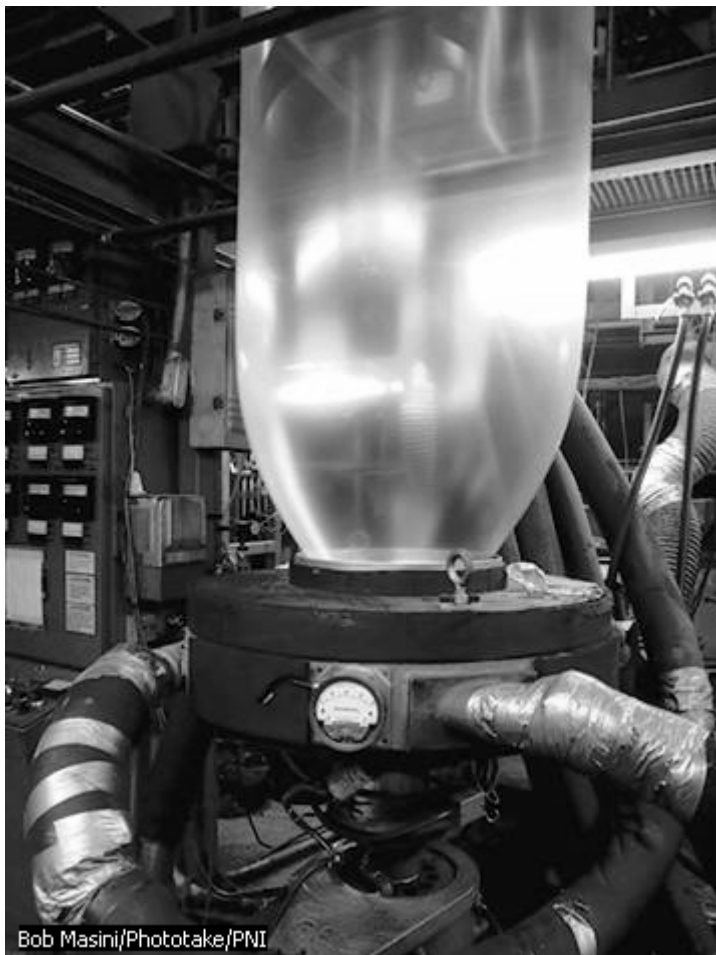
Figura 25. Proceso de soplado para películas plásticas.
