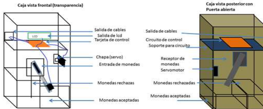
Figura 27. Ubicación de los componentes dentro del contenedor
