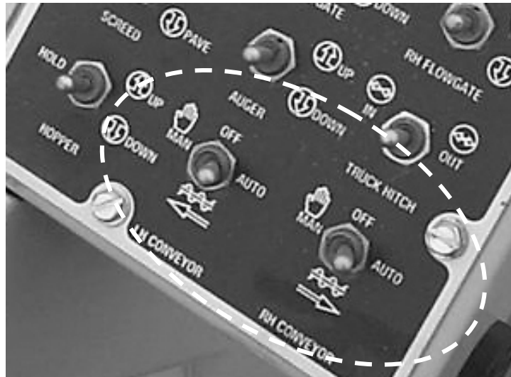
Figura 82. Interruptor de transportador de material en automático
