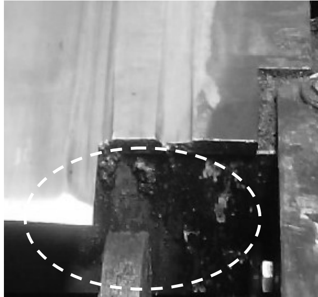
Figura 121. Desgaste de placas de transportador de paletas
