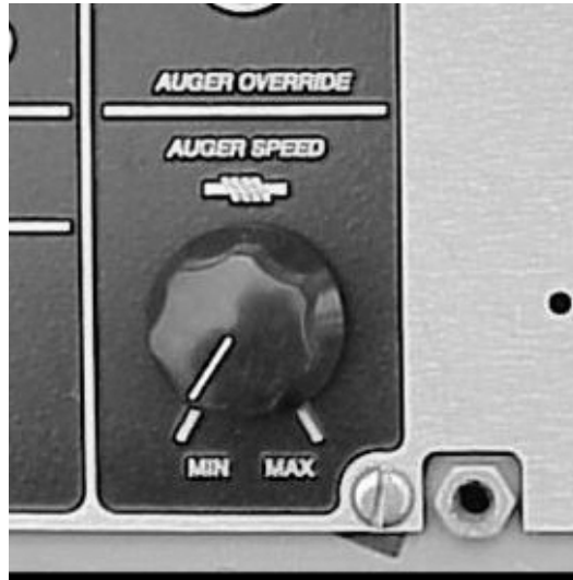
Figura 83. Control de velocidad de transportadores de material
