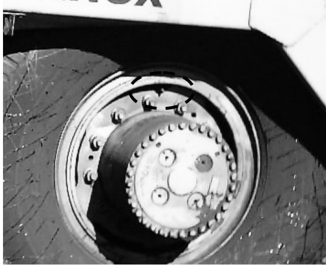
Figura 75. Válvula de llenado ubicada en la parte superior del aro
