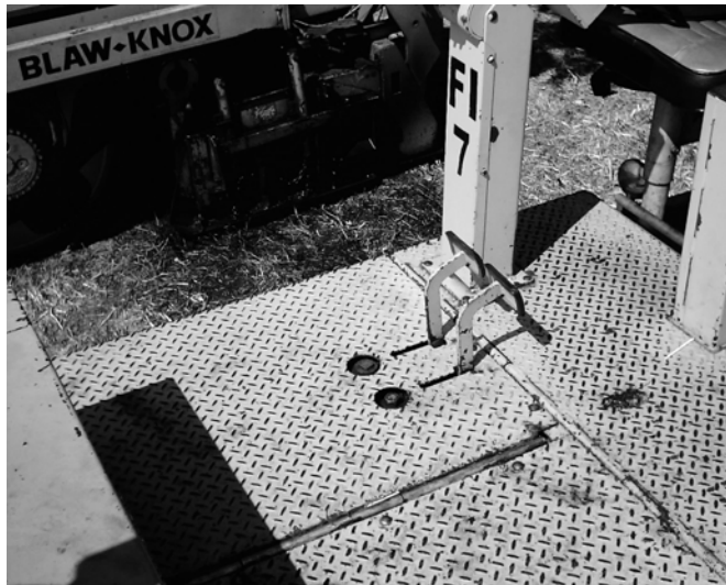
Figura 59. Pedales de freno y tapones de llenado de bombas
