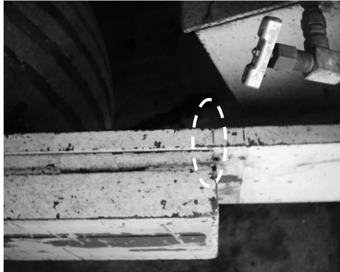
Figura 115. Corrección de distancia de plancha y tornillo sinfín
