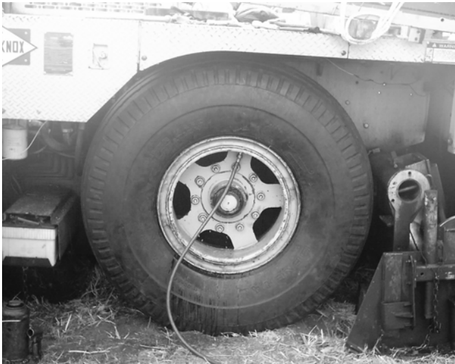
Figura 77. Manguera tipo residencial para llenar neumático de agua
