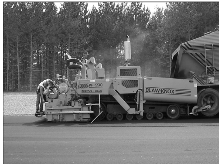
Figura 1. Pavimentadora con tracción de oruga o banda
