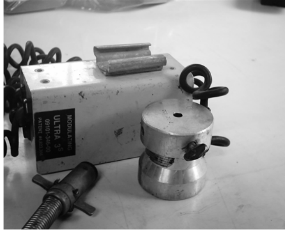
Figura 90. Sensor ultrasónico de alimentación automática
