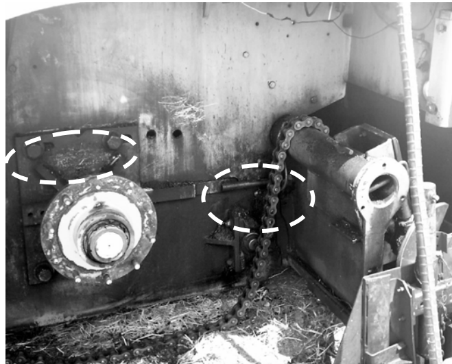
Figura 111. Tensor de cadena de tracción y tornillos de base de la rueda
