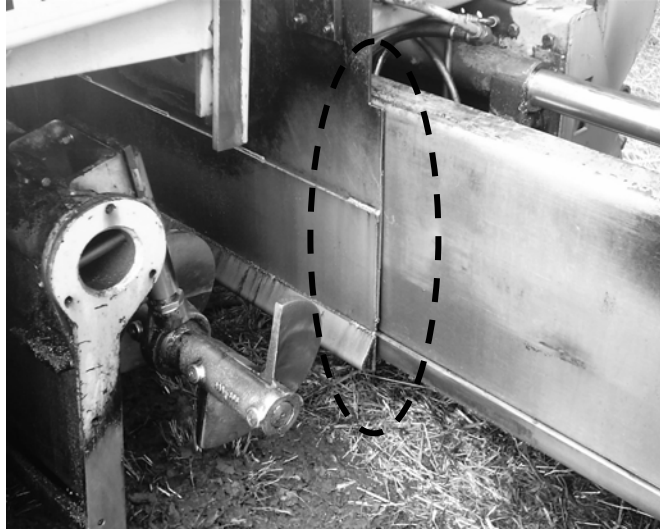
Figura 50. Placas de pre-nivelación
