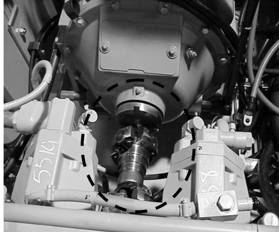
Figura 15. Eje de propulsión
