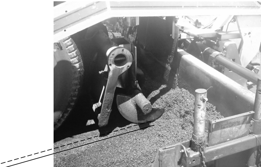
Figura 68. Altura de operación para tornillo sinfín
