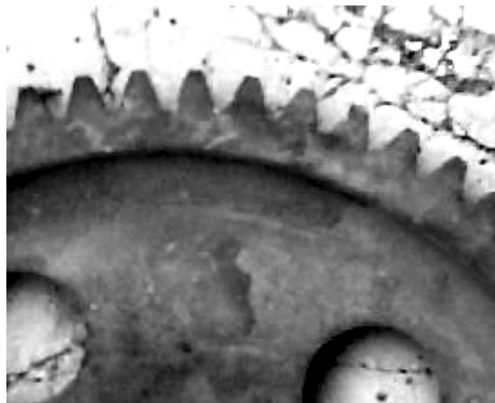
Figura 21. Engranaje de dientes con perfil recto
