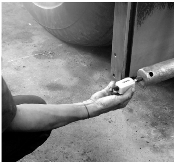
Figura 79. Medición de r.p.m. de tornillo sinfín
