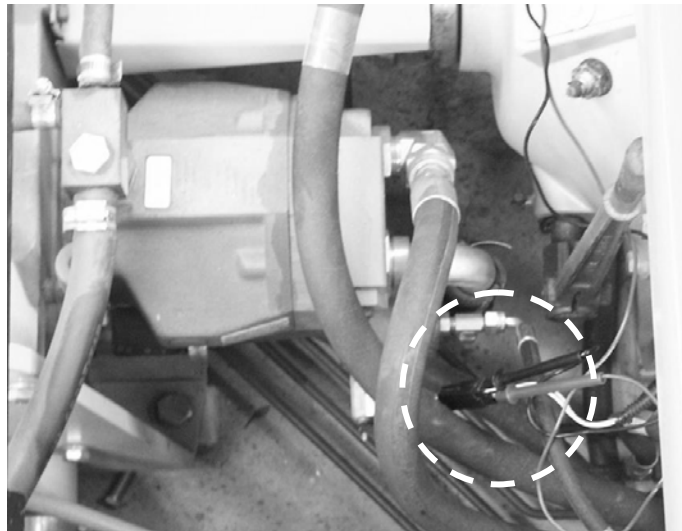
Figura 81. Conexión de multímetro en terminales de bobina
