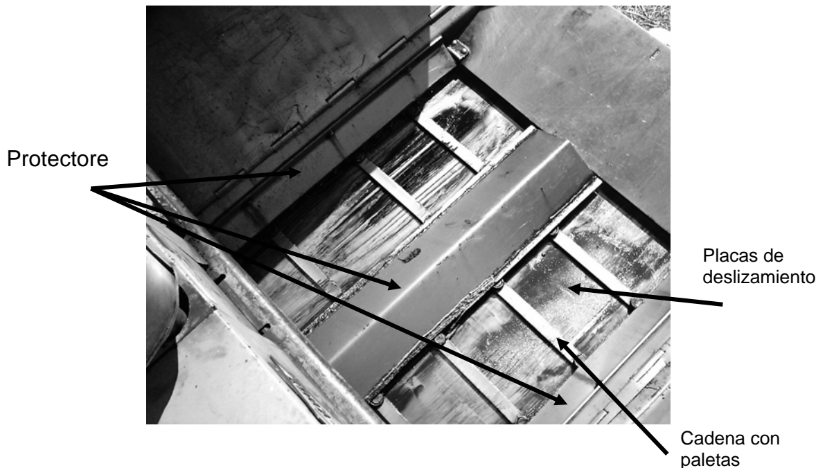
Figura 61. Tolva y transportador de paletas
