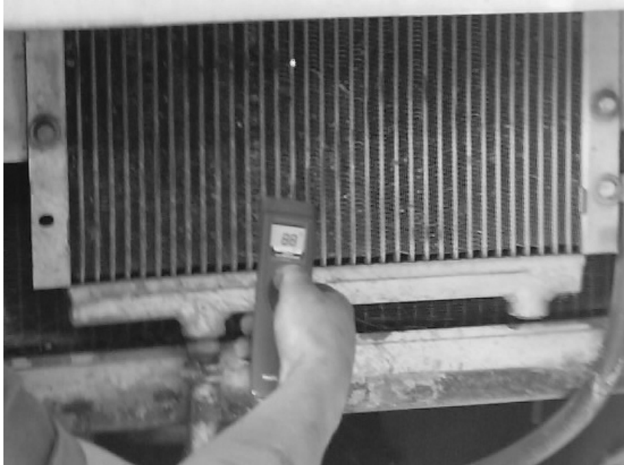
Figura 74. Medición de temperatura con termómetro ultrasónico
