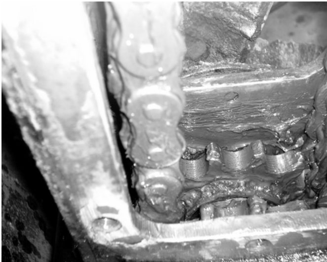
Figura 70. Sprockets para rotación de tornillo sinfín
