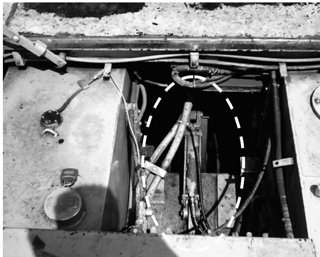
Figura 66. Cilindro de accionamiento de altura de tornillo sinfín
