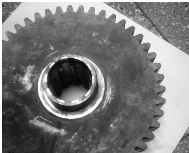
Figura 18. Engranaje central de caja de bombas
