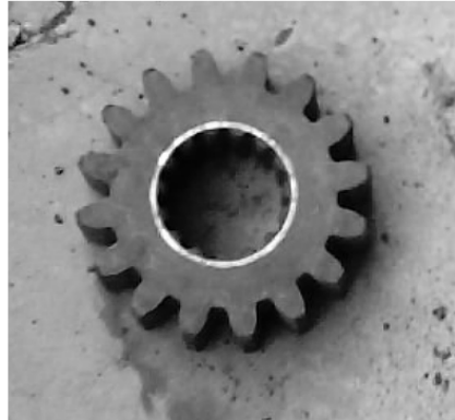
Figura 22. Engranaje de dientes con perfil modular
