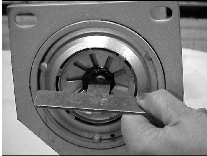
Figura 103. Herramienta de calibración de boquilla de calentador
