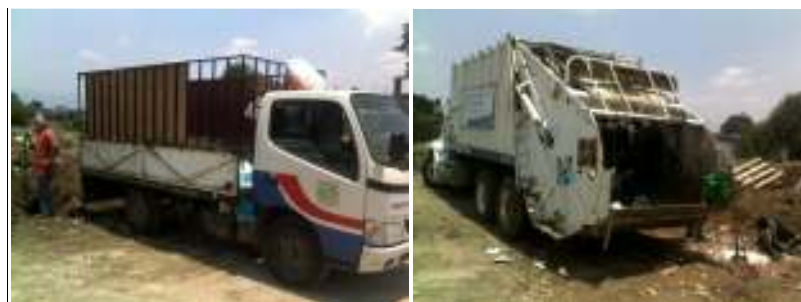
Figura 9. Camión con capacidad para 2 y 12 toneladas respectivamente
