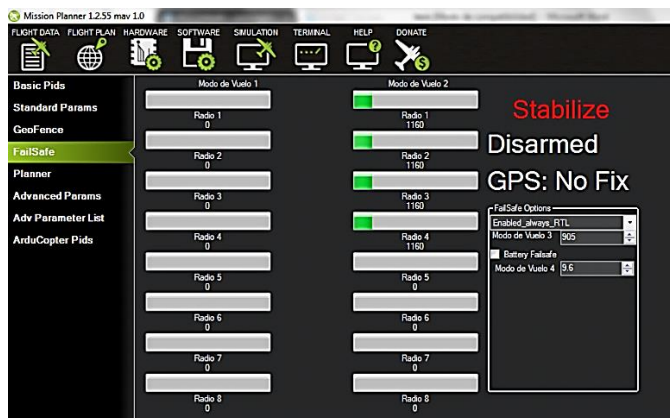
Figura 54. Pantalla configuración de modo a prueba de fallas
