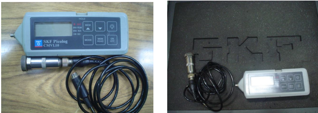
Figura 33. Medidor de vibraciones. Picolog / PRISM 2 Jr. Marca SKF
