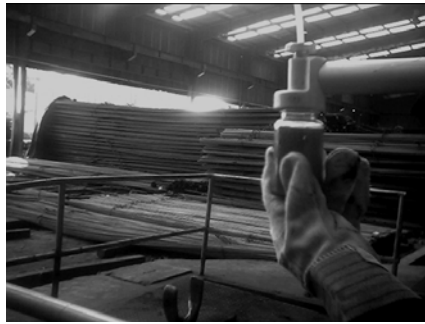
Figura 35 Muestra de aceite usado que se envía al laboratorio
