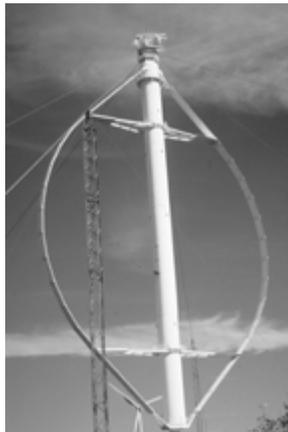
Turbina eólica de eje vertical
