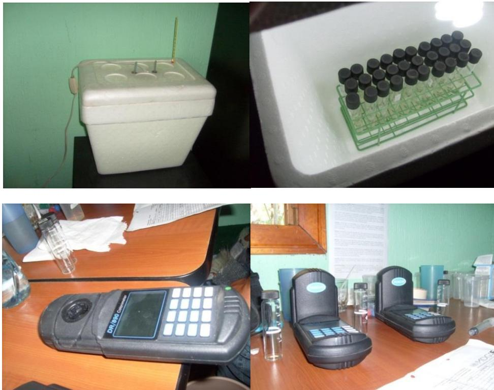
**Figuras 62, 63, 64 y 65. Incubadoras portátiles para análisis bacteriológicos y equipos Multiparametricos portátiles para análisis Físicoquímicos. Fuente: propia.**
