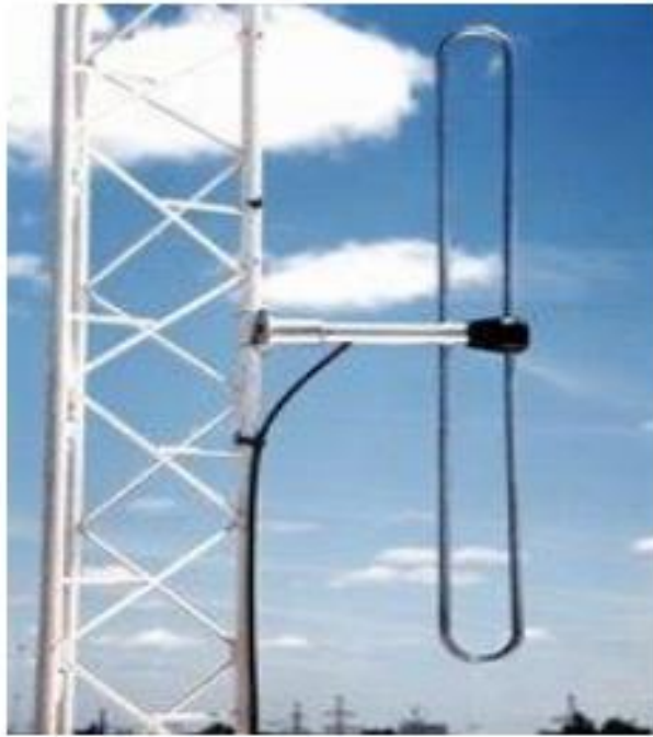
Figura 41. Antena de recepción dipolo doblado
