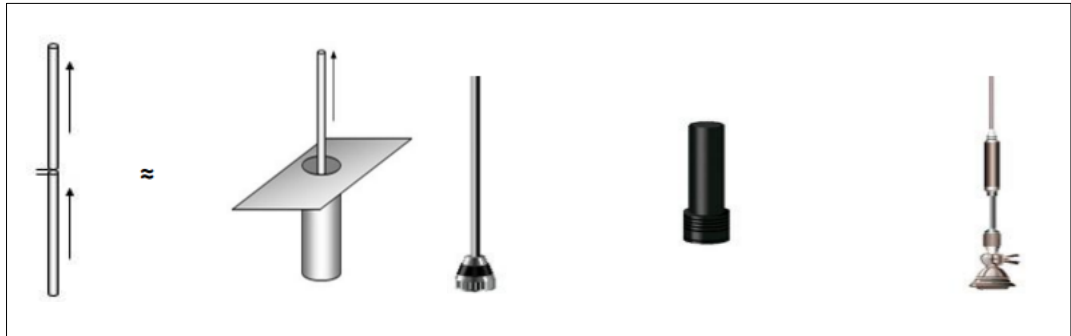
Figura 42. Equivalencia de un dipolo y un monopolo y distintos monopolos
