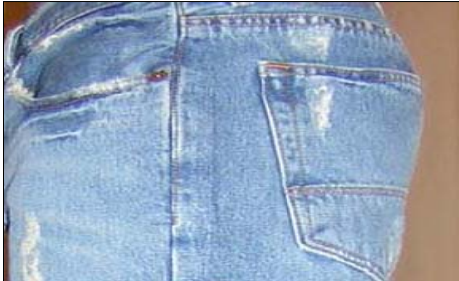
Figura 5. Acabado especial destrucción en costado de pantalón.
