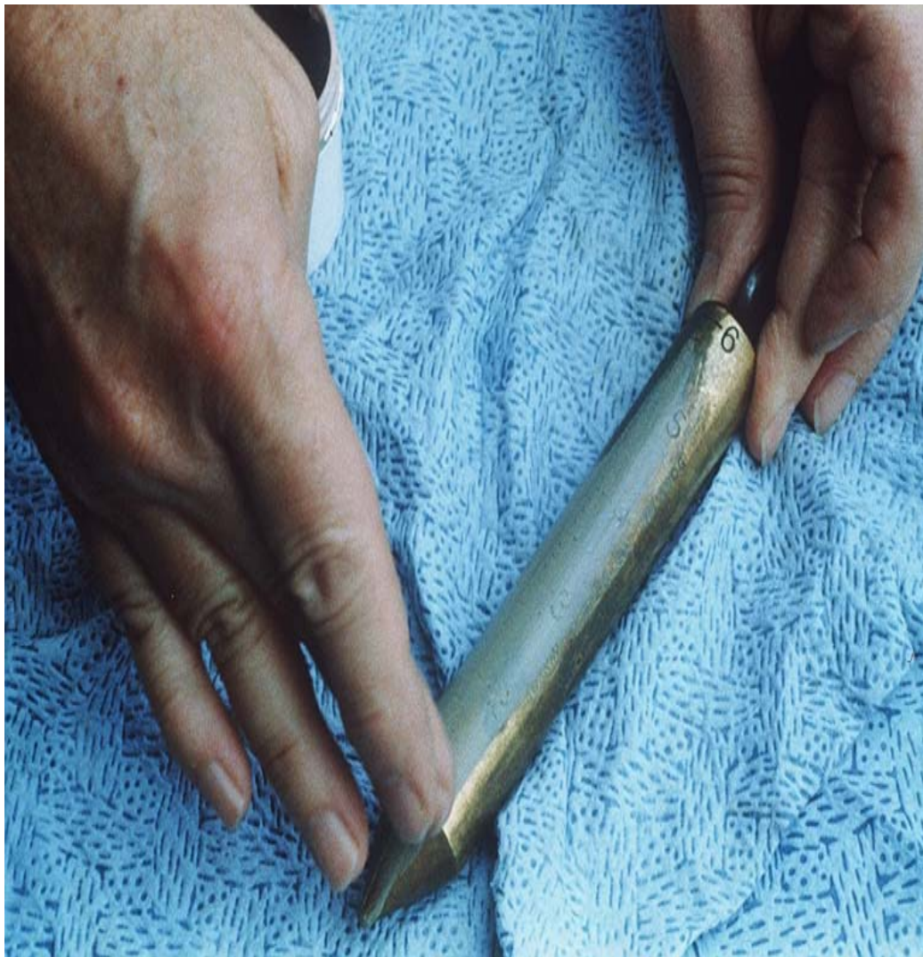
Figura 4. Aplicación de la pasta para detectar agua.
