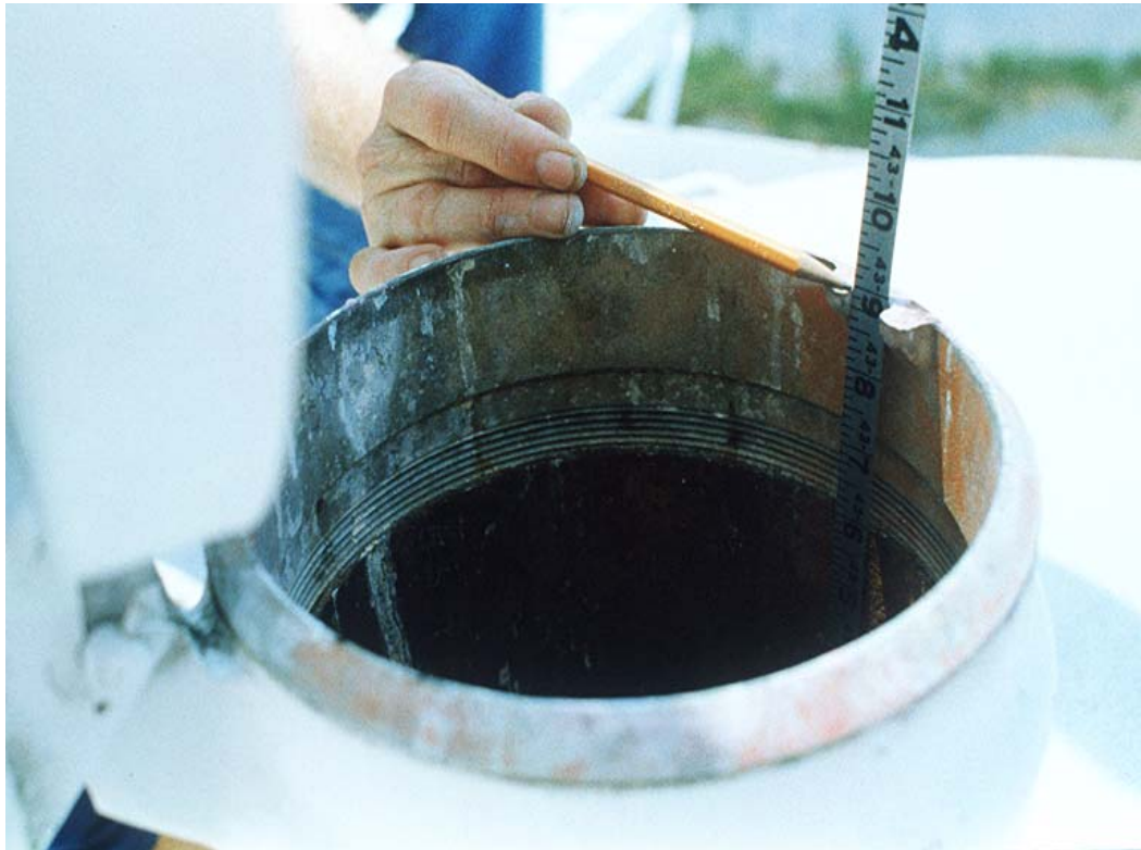
Figura 35. Lectura del nivel de producto petrolero
