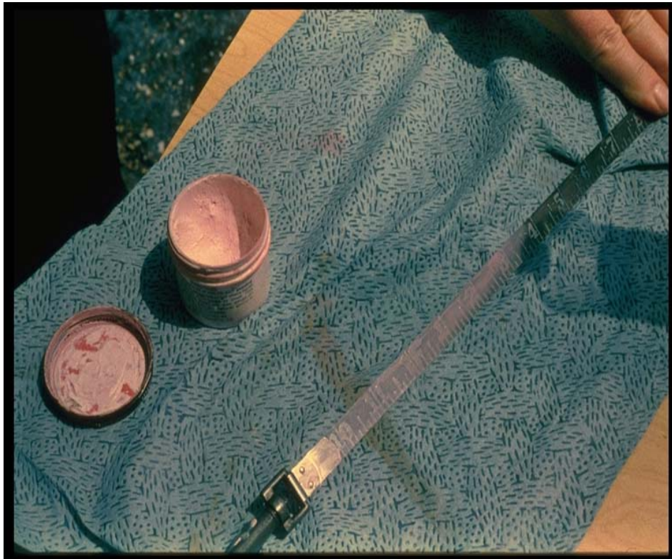
Figura 5. Aplicación de la pasta para detectar productos petroleros.
