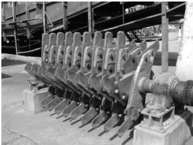
**Figura 23. Instalación cuchilla picadora**
