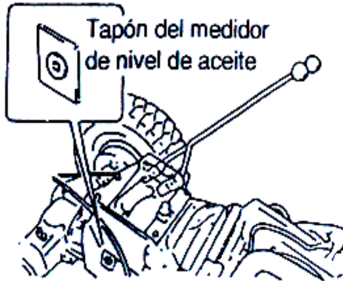
Figura 18. Medición del nivel de aceite de la transmisión
