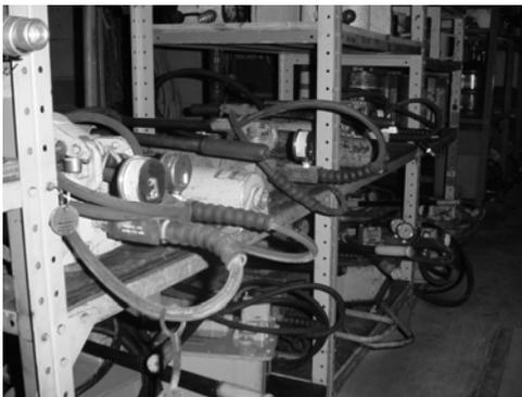
**Figura 5. *Tricketts* hidráulicos**
