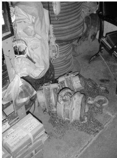
Los polipastos del *Tool Room*, debido al uso constante y muchas veces inadecuado, tienen una vida útil corta, provocando una renovación continua de los mismos, ésto se refleja en los siguientes datos obtenidos del inventario: el 63% de los polipastos se encuentran en buenas condiciones, el 15% regulares y el 22% están en mal estado.
