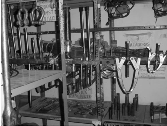
**Torques.** La colocación de los torques dentro del *Tool Room* es en estantes y colgantes (figura 10). Casi la mitad de dicha herramienta se encuentra en mal estado (41%) y el 56% se encuentra en buenas condiciones. La calibración de éstos no es muy regular y se calibran únicamente cuando se envían a reparación.
