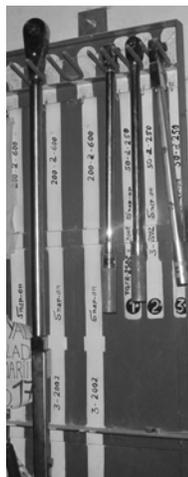
**Herramientas neumáticas.** Debido a su naturaleza tienen una vida útil larga comparada con otros equipos en el *Tool Room*. Su disposición dentro del *Tool Room* es en colgantes. El porcentaje de herramientas que se encuentran en condiciones de operación es de 74%, mientras que el 26% están en mal estado. Al ser utilizadas dichas herramientas en campo, éstas no cuentan con unidades de mantenimiento, para mantener la presión de trabajo, calidad del aire y lubricación adecuada del equipo.
