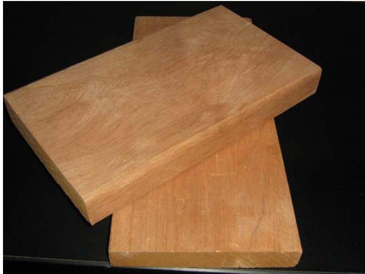
Figura 4. Decking piso exterior
