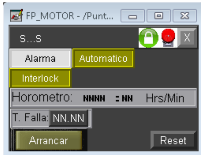
Figura 26. Faceplate de arranque de motor utilizando arreglo contactor, guardamotor
