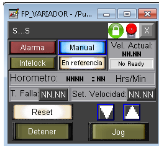
Figura 24. Faceplate de arranque de variador
