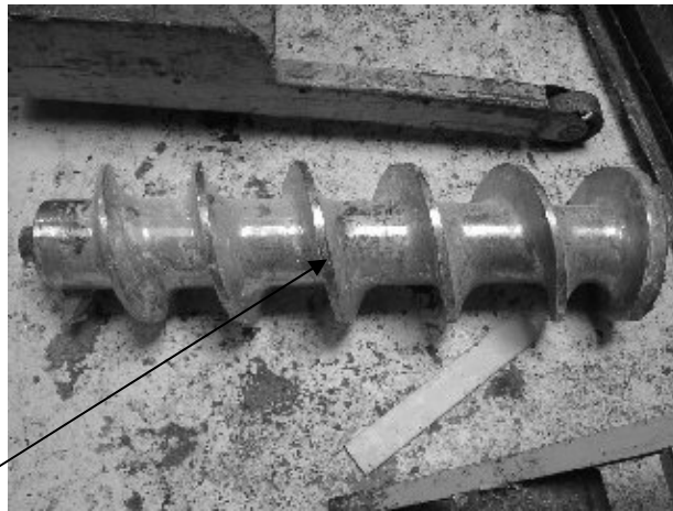
Figura 41. Gusano extrusor y volante principal del refinador primer paso
