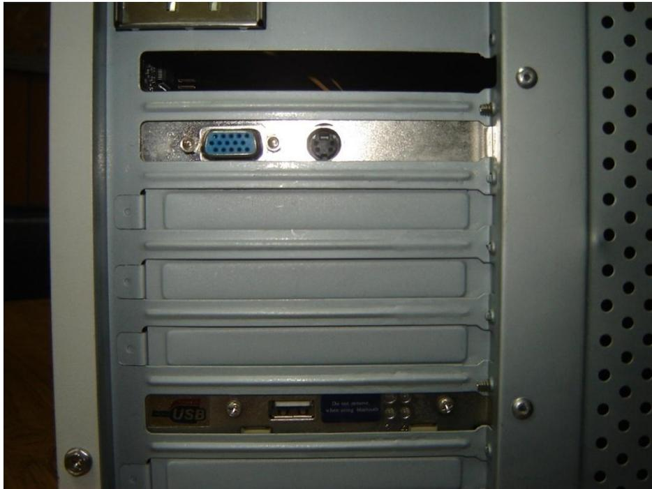
El cable Super Video (S-Video) se conecta en un extremo con la tarjeta de video instalada en el computador (ver figura 6).
