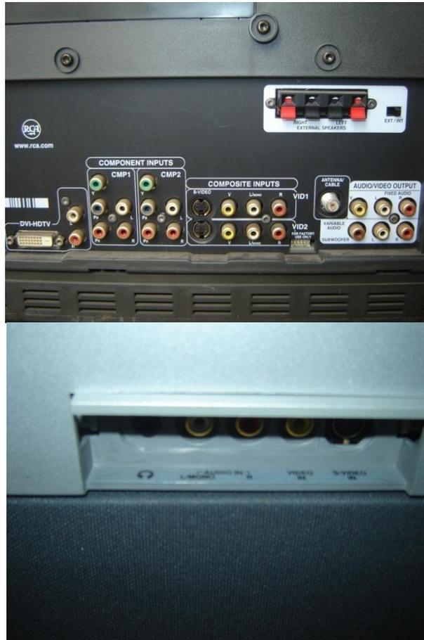
El cable Super Video puede conectarse en la parte frontal o posterior del televisor (ver figura 11), pero al momento de encender el televisor para visualizar la imagen, se debe elegir la fuente de video según a donde se halla conectado el cable.
