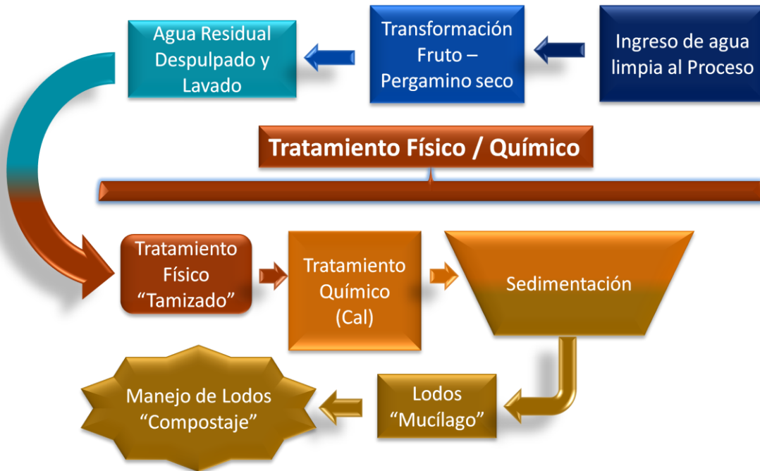
Figura 3. Proceso del beneficiado húmedo del café
