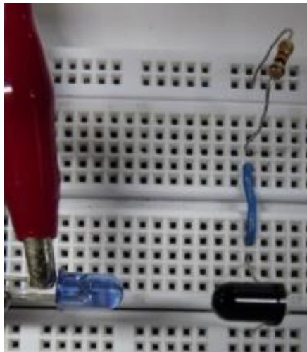
Figura 130. Alineación de emisor y receptor infrarrojo
