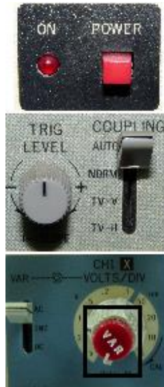
Figura 36. Posición adecuada de los controles del osciloscopio antes de medir una señal
