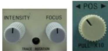
Figura 40. Controles de intensidad, focus y posición horizontal
