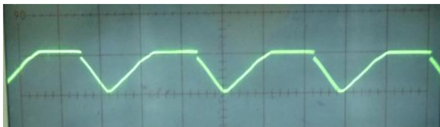
Figura 140. Salida de un circuito rectificador onda completa
