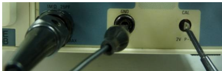
Figura 46. Conexión de la punta de osciloscopio a la calibración
