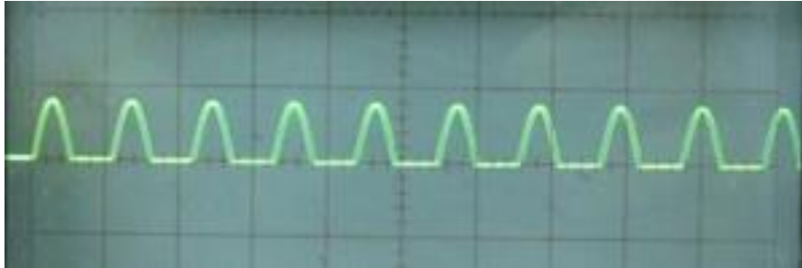
Figura 137. Salida de un circuito rectificador de media onda
