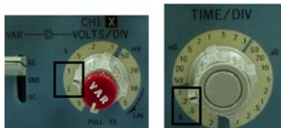
Figura 37. Posición de los controles de voltios por división y tiempo por división
