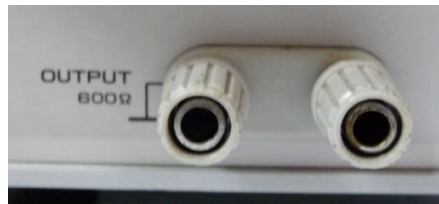
Figura 47. Salida del generador de señal
