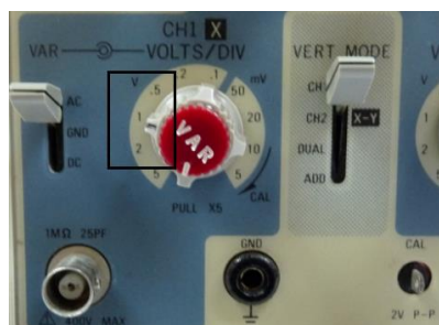
Figura 43. Control de voltios por división a 1 volt/div
