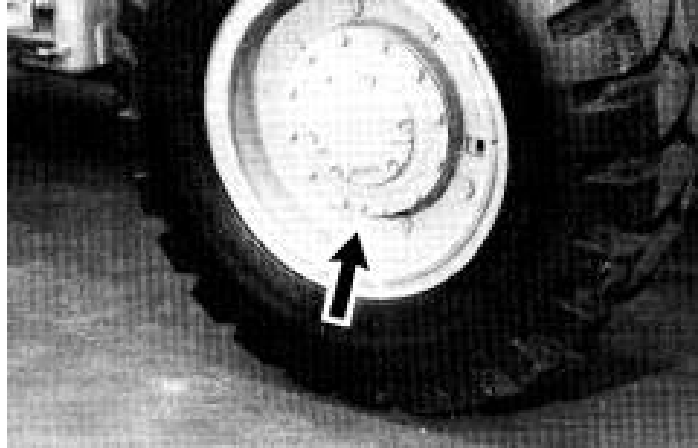
Figura 66. Fotografía de drenado de aceite de mandos finales en un cargador 930
