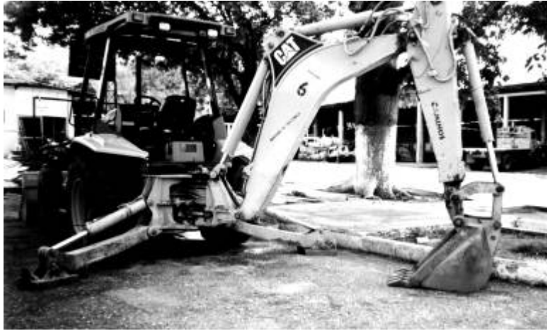
Figura 35. Fotografía de la parte trasera de la retroexcavadora 416C
