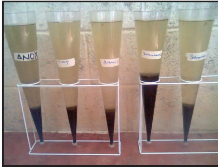
Figura 6. Ensayo de laboratorio para determinar sólidos sedimentables
