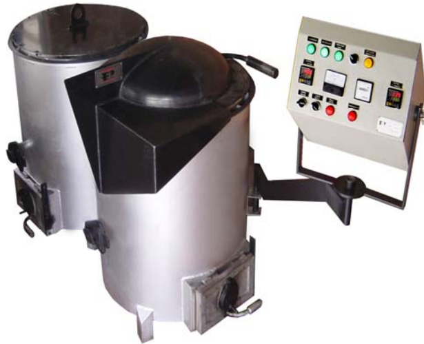
Figura 5. Incinerador con capacidad para quemar hasta 2 toneladas de desechos por hora
