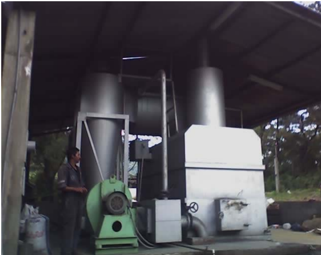
Figura 5. Incinerador con capacidad para quemar hasta 2 toneladas de desechos por hora
