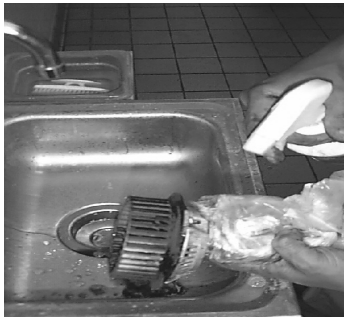
FIGURA 20. Limpieza del motor ventilador
