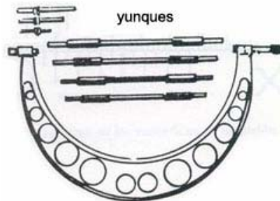
Figura 22. Micrómetro de tipo yunque intercambiable
