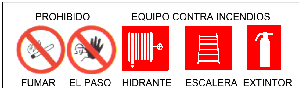
Figura 46. Señales de prohibición y equipo contra incendios.
