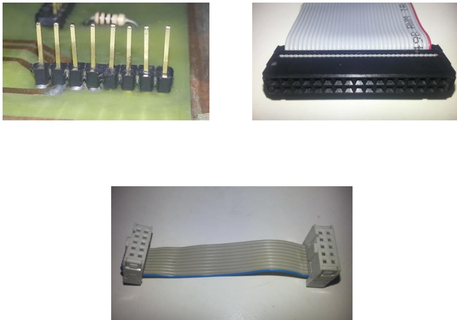
Figura 23. Cableado de interconexión
