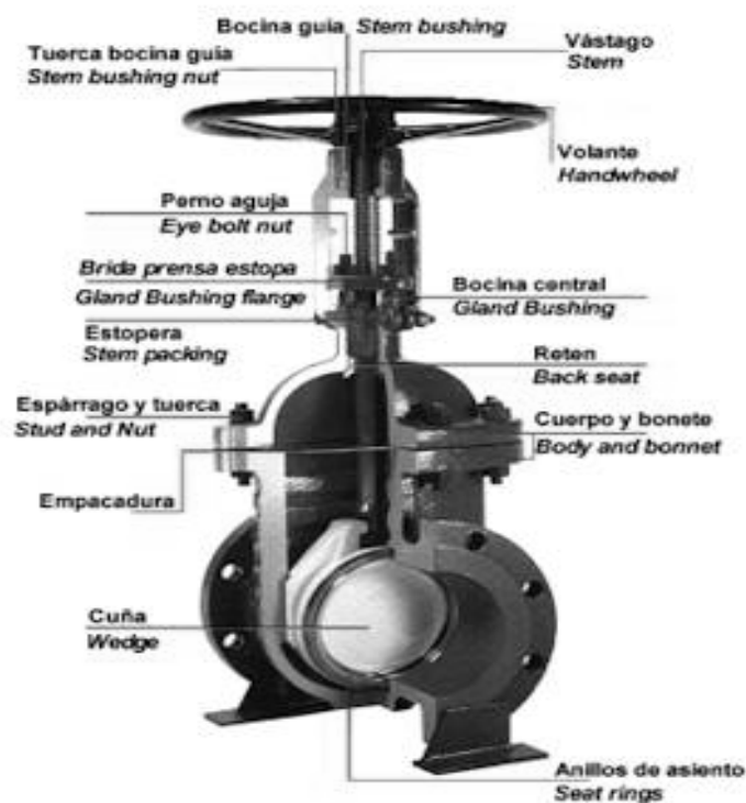
Figura 4. Válvula de compuerta
