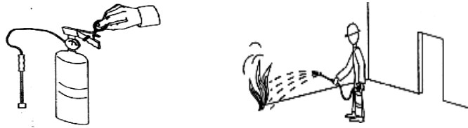
Figura 4. Tirar de la anilla, con una mano coger la manguera y dirigirla hacia el fuego, mientras con la otra apretar la válvula de salida del agente extintor y así apaga el fuego.
