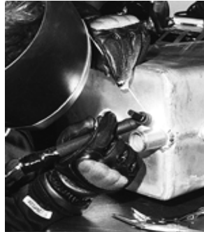
Figura 31. Proceso de soldadura tig.
