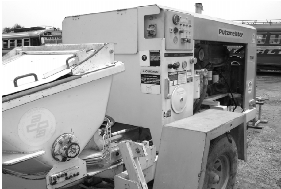
Figura 2. Máquina de producción, distribución y bombeo de concreto.
