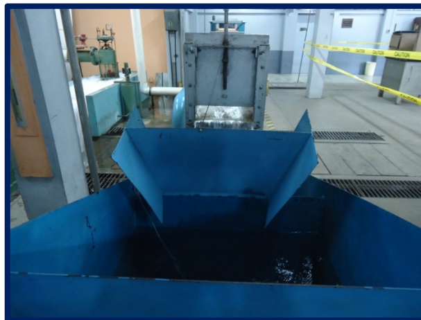
Figura 12. Canal para aforar boquilla de dispositivo
