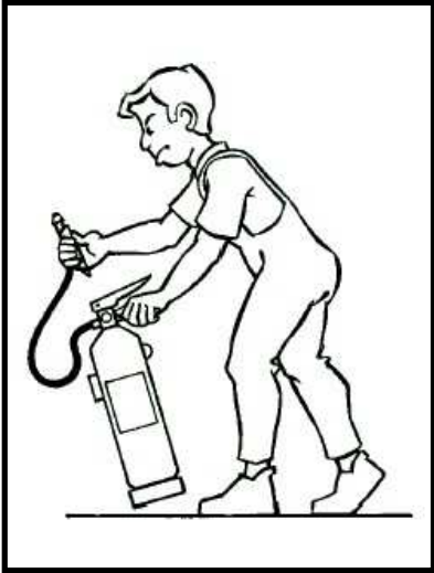
Figura 49. Remover el seguro del extintor.
