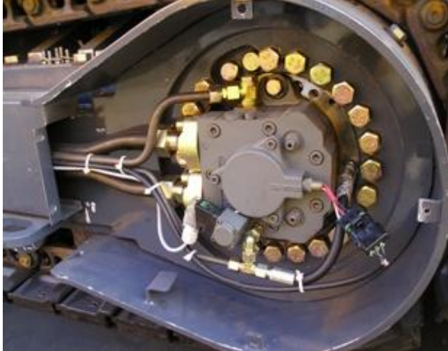
Figura 30. Tornamesa de desplazamiento y dirección
