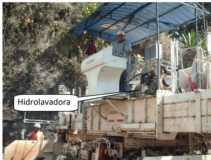
Figura 50. Hidrolavadora de alta presión, ubicada de forma permanente como equipo secundario en pavimentadora o esparcidora de concreto
