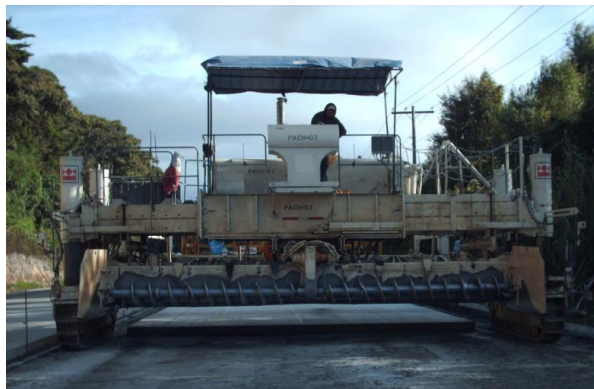
Figura 10. Máquina pavimentadora o esparcidora TEREX SF3502B
