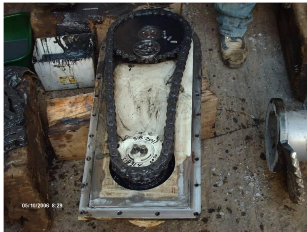
Figura 17. Carenaje principal del eje o caracol de esparcido de concreto
