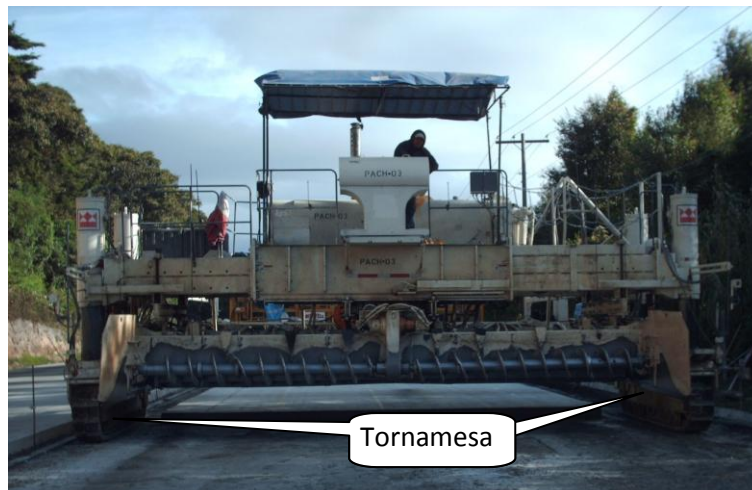
Figura 29. Tornamesa de desplazamiento y dirección
