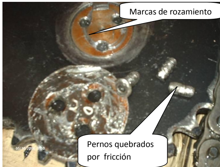
Figura 21. Pernos del engrane de rotación de eje
