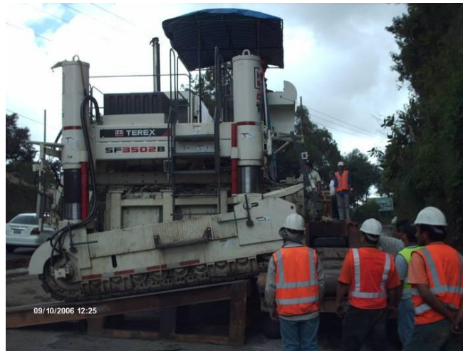
Figura 7. Maniobras para traslado de equipo primario (pavimentadora o esparcidora de concreto) hacia planta de distribución para realización de mantenimiento mayor
