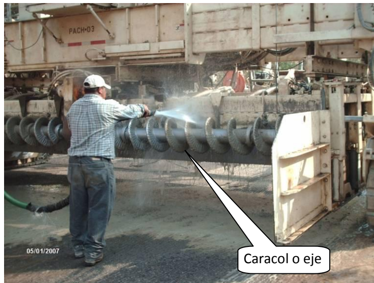
Figura 24. Limpieza superficial profunda del eje o caracol de esparcido
