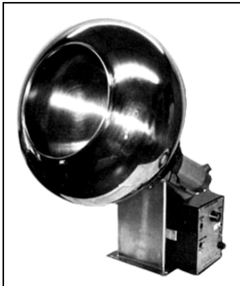
Figura 9. Tambor de absorción para confitado de chicle
