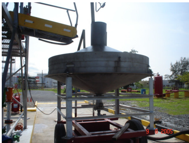
Figura 8. Probador volumétrico de 535 gls., llamado también Serafín.
