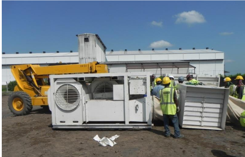
Figura 45. Inflador ( inflator ): el ventilador o conjunto de soplado
