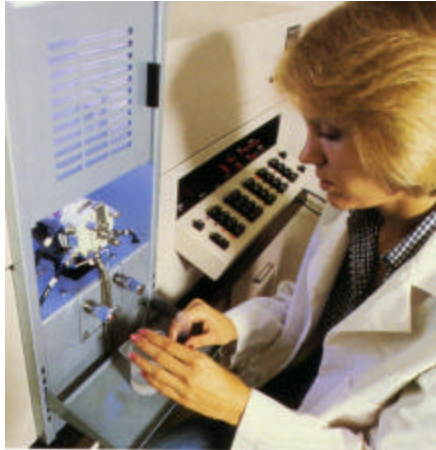
Figura No. 10. Análisis de una muestra de aceite mediante espectrofotómetro de absorción atómica.
