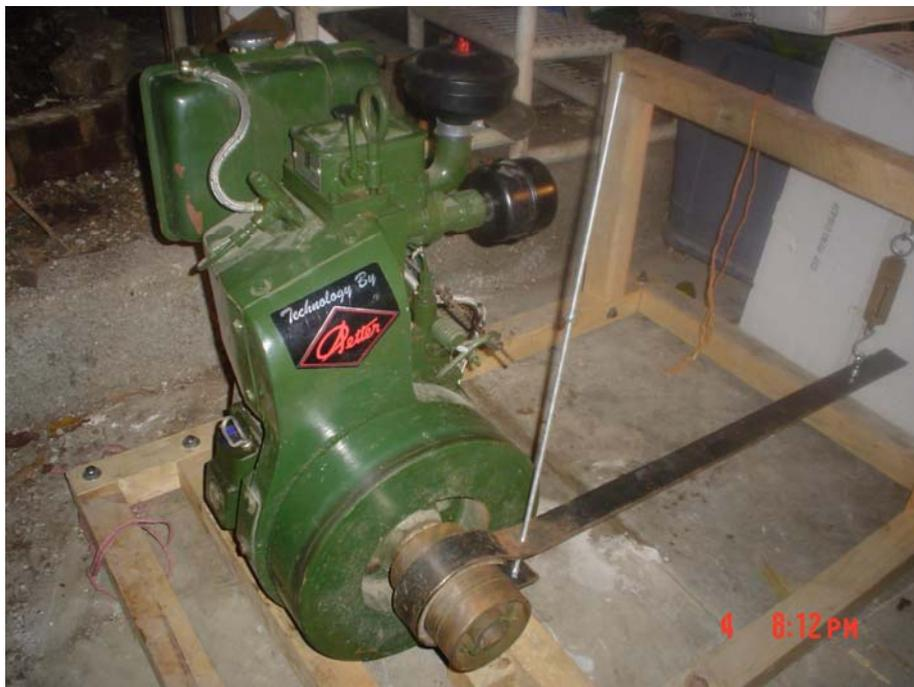
**Figura 21. Instalación del freno de prony**
