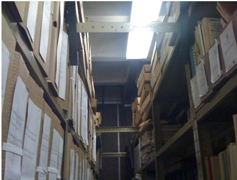
Figura 3 - Sobrecarga de los estantes y altura excesiva en área de almacén
