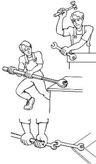
Figura 41. Utilización inadecuadamente de llaves
