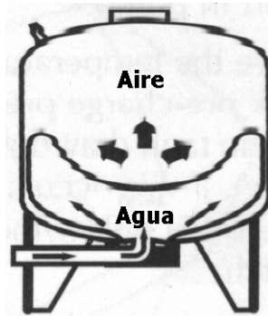
Figura 9. El agua comienza a entrar al tanque
