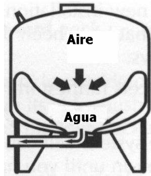
Figura 11. El tanque está entregando el volumen de agua acumulado
