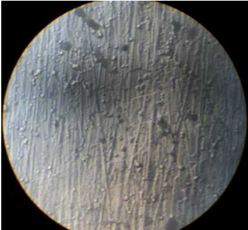
Figura 24. Microfotografía del material base, estructura step según ASTM A 262 100 x ataque ácido oxálico 10 %, 15 v a 1,5 A/cm 2 3,5 minutos
