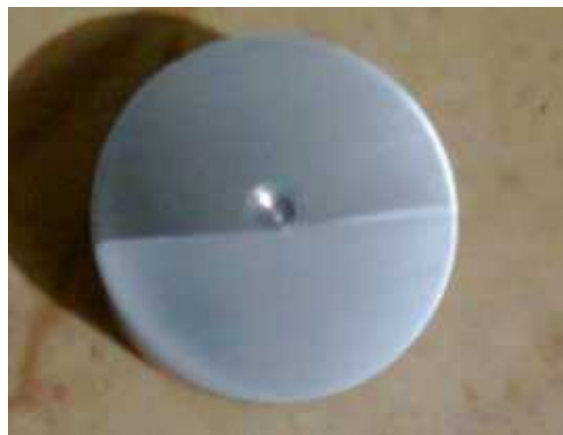
Figura 23. Redondo aplicado el ataque con ácido oxálico y sección de plancha soldada método convencional
