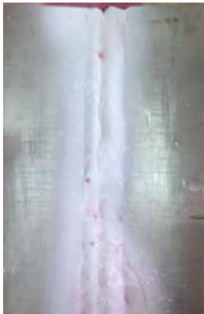
Figura 22. Aplicación de líquidos penetrantes, revelador (derecha), penetrante (izquierda) a platina de (a) método convencional y (b) método propuesto
