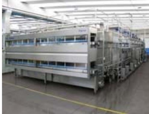
El warmer se encarga aumentar hasta cierto nivel la temperatura del producto, con el fin de evitar la condensación sobre el envase del producto, debido a la diferencia de temperaturas entre el producto y el medio ambiente y lograr así un mejor empaque.
