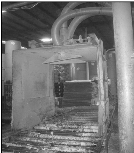
Figura 27. Máquina secadora (Tiempo promedio de secado 3.3 min.)
