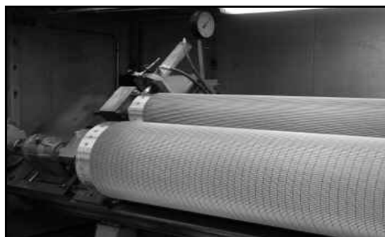
Figura 32. Rectificación de rodillos corrugadores
