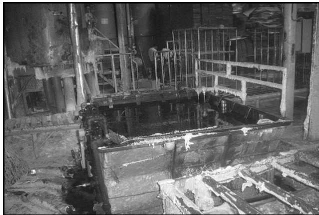
Figura 26. Depósito de parafina líquida (Temperatura aproximada 90 °C)
