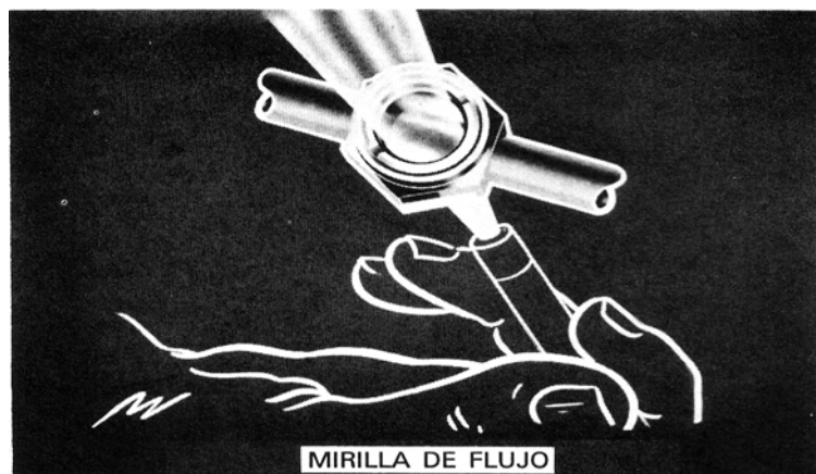
Figura 32 Visor o mirilla de flujo
